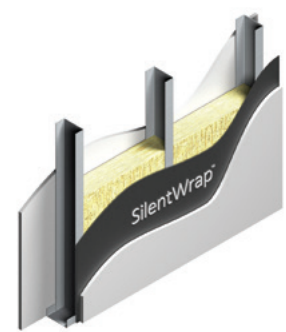
STC 53: steel stud + insulation + SilentWrap
