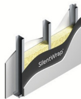
STC 53: steel stud + insulation + SilentWrap
